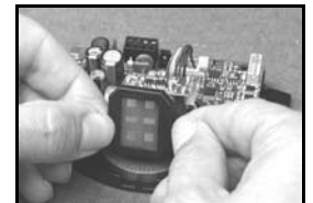
Fixer la nouvelle antenne sur son support avec l'élément de fixation.
